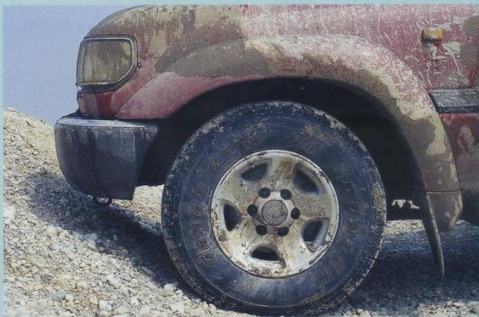
Guter vorderer Böschungswinkel (37°), aber die Alufelgen schaufeln Schmutz und Kies in die Bremsen
