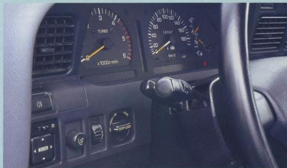
Seit 1992 serienmäßig im HDJ 80: per Drehschalter aktivierter Differentialsperren in beiden Achsen
