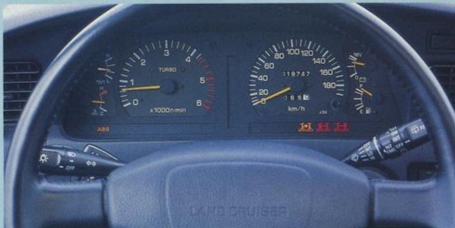
Das ABS ist nur abschaltbar, indem man die Untersetzung einlegt und so das Zentraldifferential sperrt
