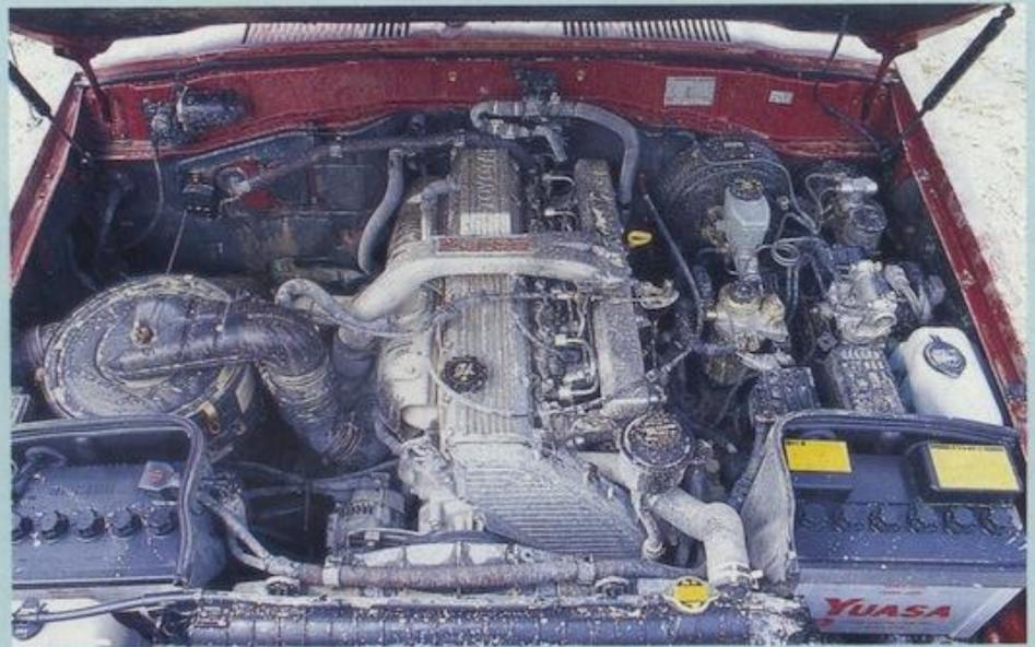
Der 4,2-Liter-Turbodiesel stellt reichlich Kraft bereit – 360 Nm maximal, 245 Nm schon bei 1000 U/min
