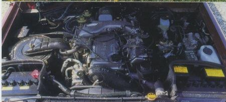
Alle LandCruiser J8 haben Reihen-Sechszylinder unter der großen Motorhaube: 4.2 Turbodiesel mit zwei Batterien (oben) oder 4.5 Benziner (unten)
