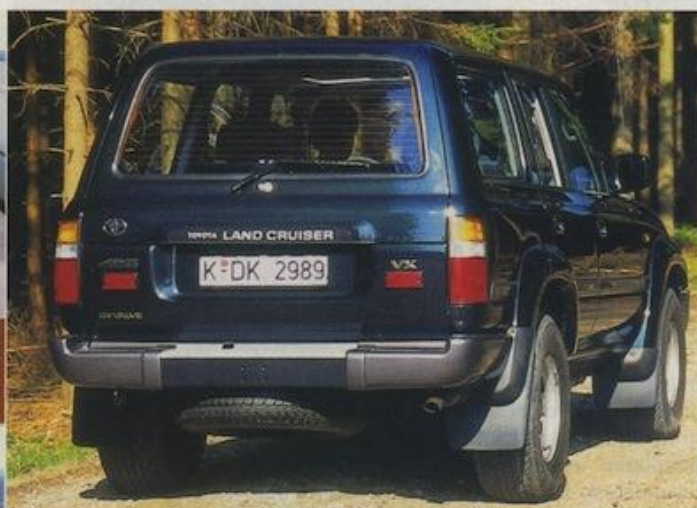
Der J8 hat eine horizontal geteilte Heckklappe. Links: Alufelgen (Special), rechts Stahl
